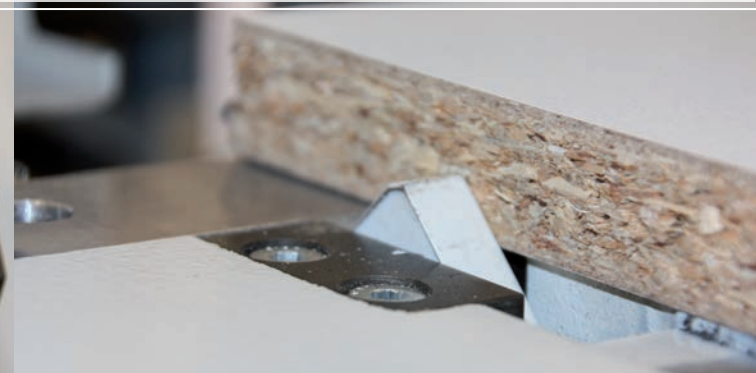
Integrierter Klappanschlag für überlange Teile
